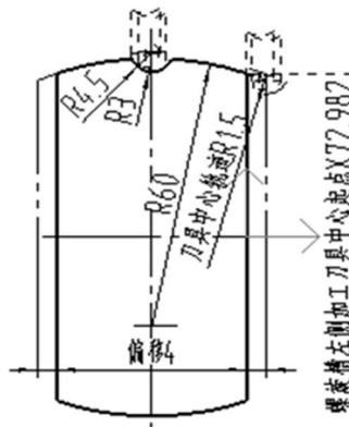
图 4 左切螺旋槽
