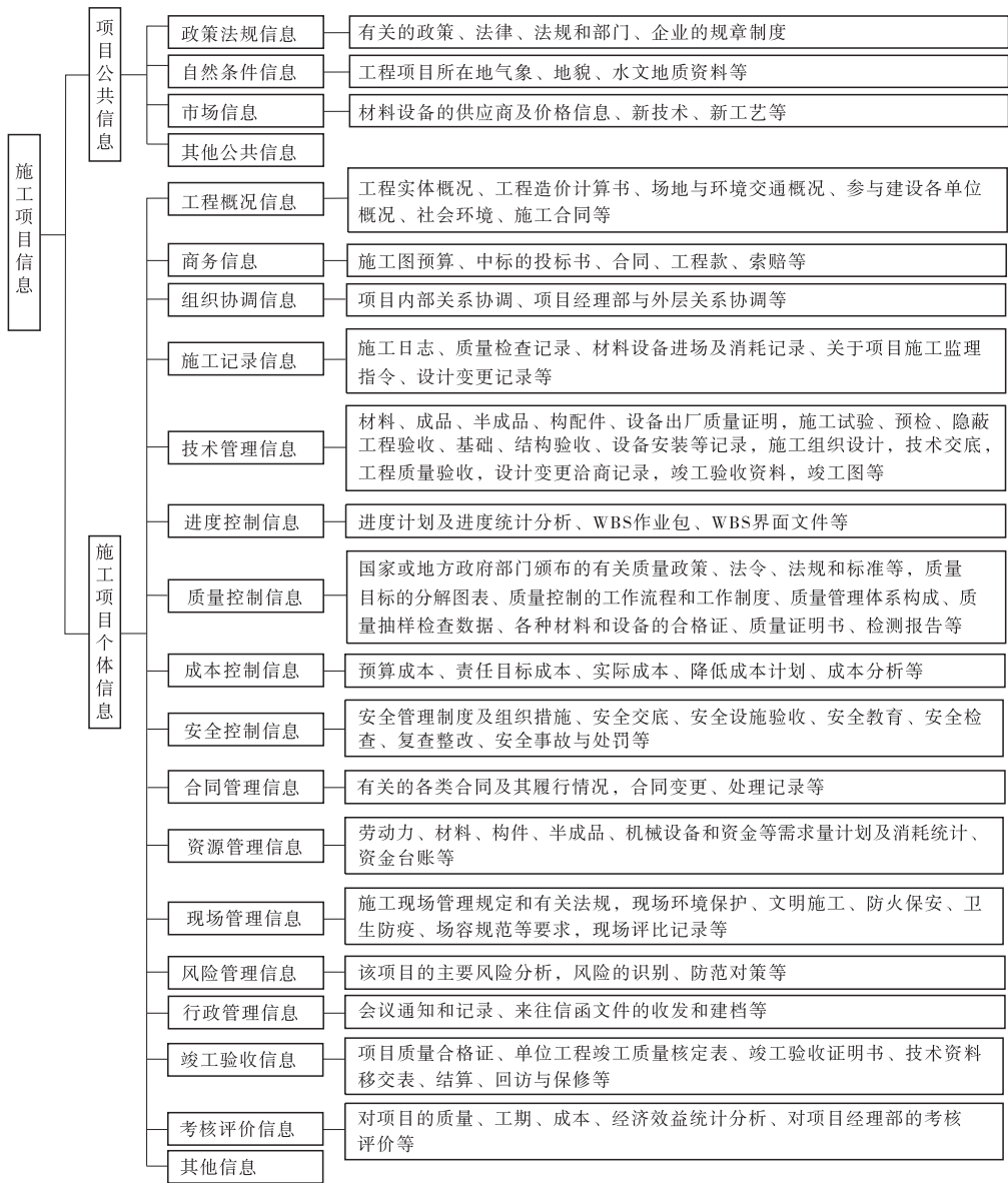
图 10-1 施工项目信息结构及内容
