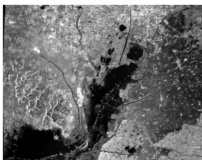
图 5 采用 SURF 算法提取特征点的拼接结果
